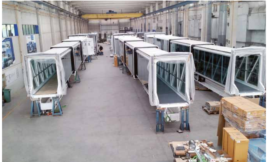
Las pasarelas se ensamblan totalmente en la factoría para ser probadas.
